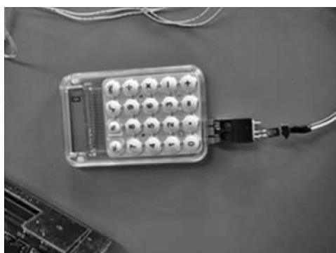
図 4. 簡易ミニ電卓とフォトカプラ PS2401-1 接続
