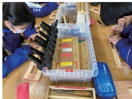
写真4 工具箱に整理した治具等とけがき作業
